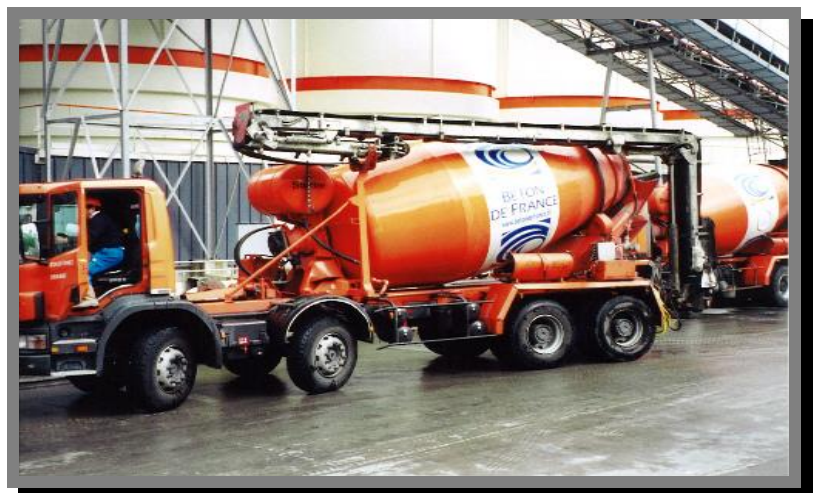
パリの生コン工場で見た『動力式シュート付ミキサー車』
