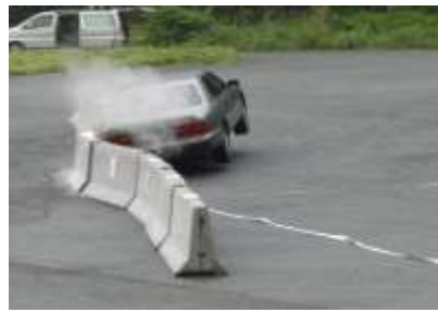
車両後部が防護柵に衝突
